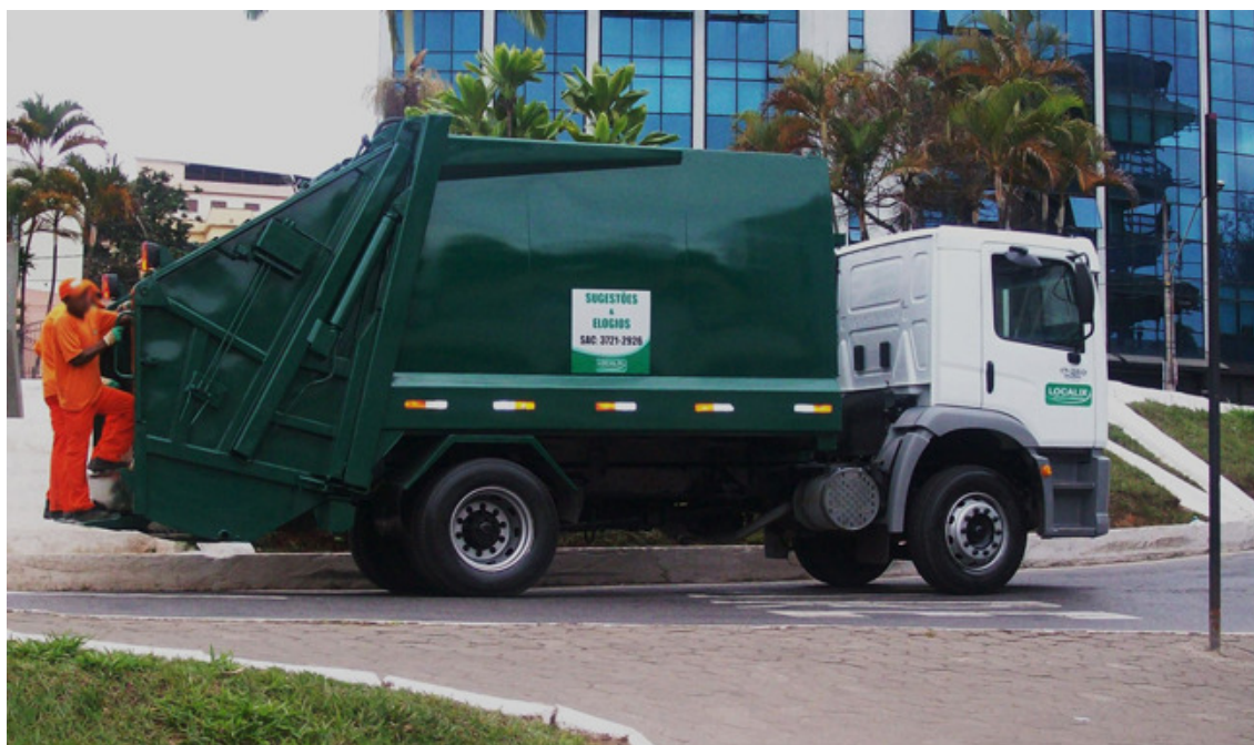
Foto 01: Caminhão compactador usado na coleta de RSU
