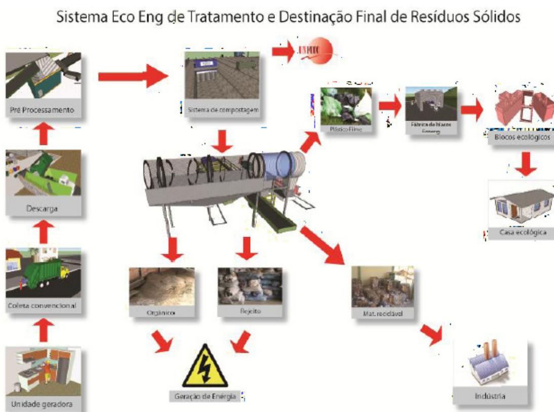
Figura 16: Sistema Eco Eng - Tratamento e destinação Final de Resíduos Sólidos
