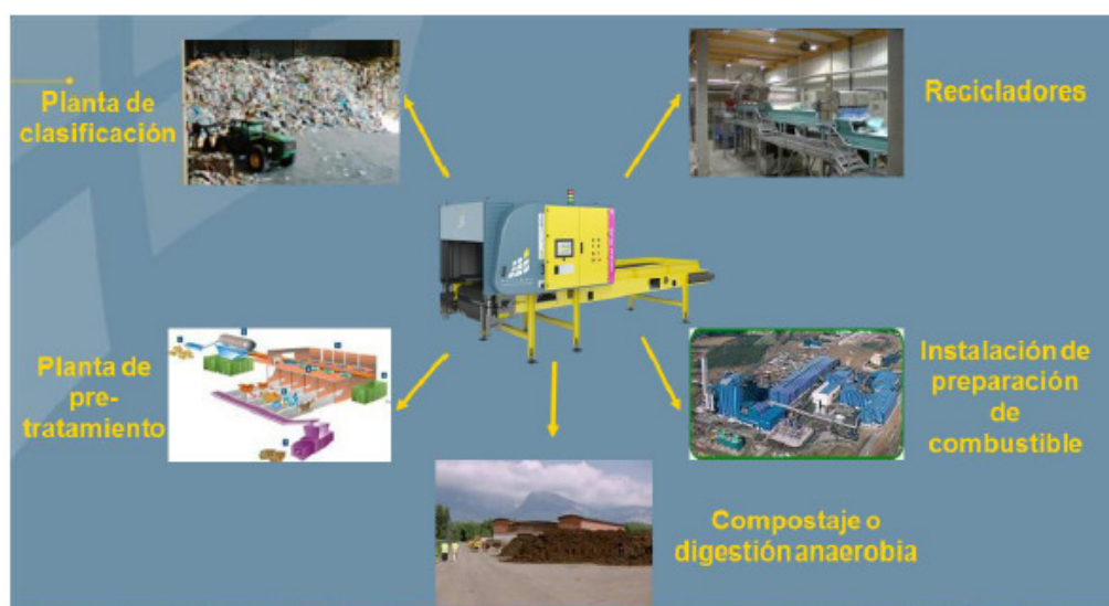
Figura 21: Esquema do processo contemplado na tecnologia Pellenc
